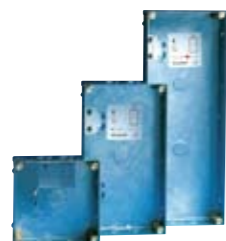
3160 Scatola da incasso Realizzata in lamiera zincata da 1,5mm di spessore, complete di appositi distanziatori per l'unione e la messa in dima di più scatole. N. Moduli Articolo Dimensioni 1 3160/1 130x130x58 mm 2 3160/2 130x242x58 mm 3 3160/3 130x354x58 mm
