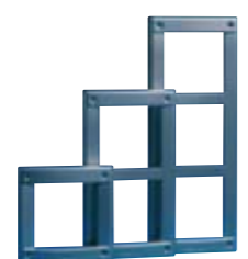
3161 Telaio Realizzato in pressofusione di alluminio e verniciato con particolari vernici a polveri resistenti in ambiente esterno. Colore grigio scuro. N. Moduli Articolo Dimensioni 1 3161/1 143x143x18 mm 2 3161/2 143x255x18 mm 3 3161/3 143x367x18 mm
