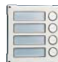
3264 Modulo di chiamata con 4 pulsanti. Sistema VIP Realizzato con doppia piastra in acciaio inox da 2,5 mm completo di 4 pulsanti in acciaio inox, con cartellino portanomi retroilluminato. Dimensioni: 106x106x21 mm.
