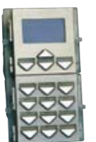
3370 Modulo digitale di chiamata completa di rubrica elettronica. Sistema VIP Modulo digitale di chiamata completo di rubrica elettronica con display LCD grafico 128x64 dots e tastiera 16 pulsanti retroilluminati con LED blu. Funziona anche da chiave elettronica a codice. La rubrica elettronica memorizza 1000 nomi di utenti. Lo scorrimento dei nomi avviene agendo su due pulsanti di ricerca oppure digitando direttamente l'iniziale del nome. Una volta visualizzato il nome dell'utente desiderato basta premere il pulsante di chiamata. È possibile inviare la chiamata anche digitando direttamente il codice utente. Dimensioni: 112x180x40 mm.
